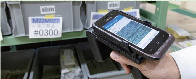
▲RFIDタグの情報を読み取るハンディ端末
