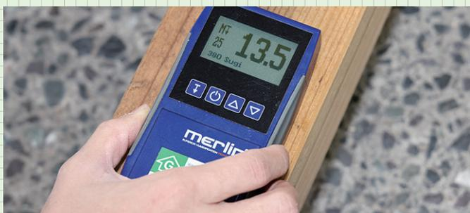
▲含水率が木材の強度を左右するため、含水率計での測定は必須
