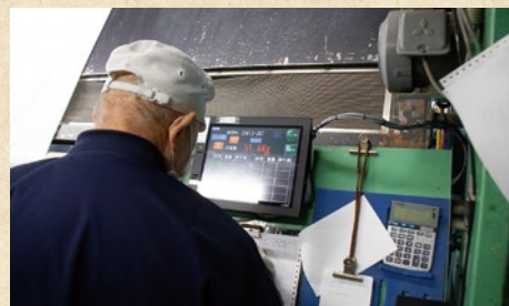
解反後に芯の重量を計って生地のをさを計算機で算出していた作業をIoTで自動化
