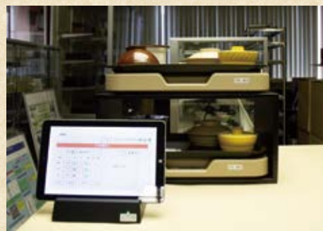
IHコイルごとに火力設定ができ、献立に合わせた加熱調理に対応
